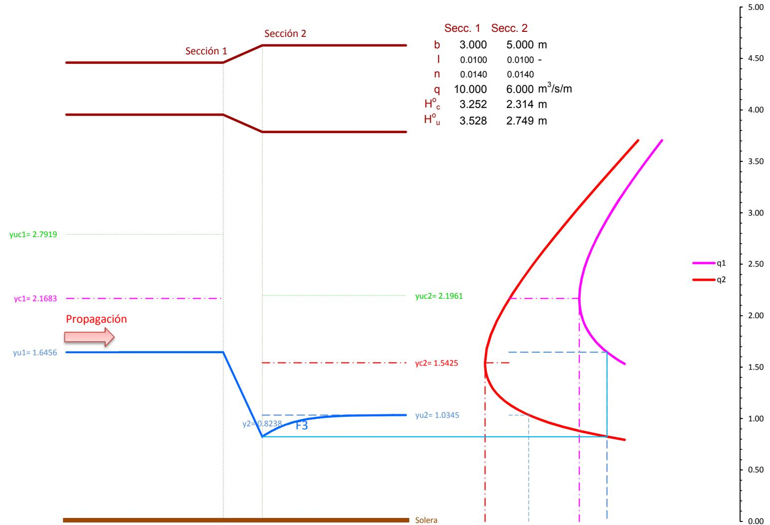
Figura 7.23: Ensanchamiento en régimen rápido sin cambio de régimen y curva  $F3$
