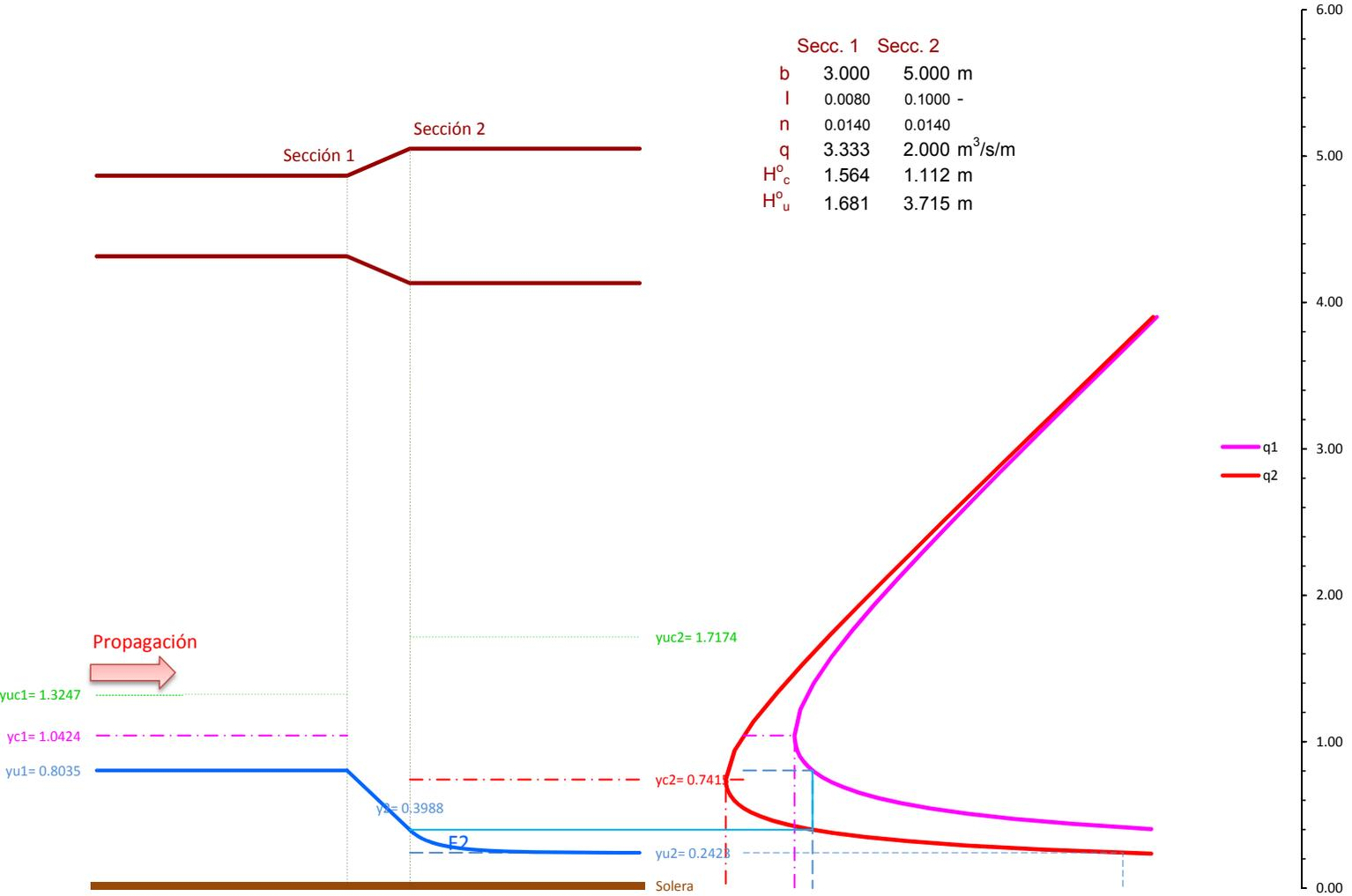
Figura 7.24: Ensanchamiento en régimen rápido sin cambio de régimen y curva F2
