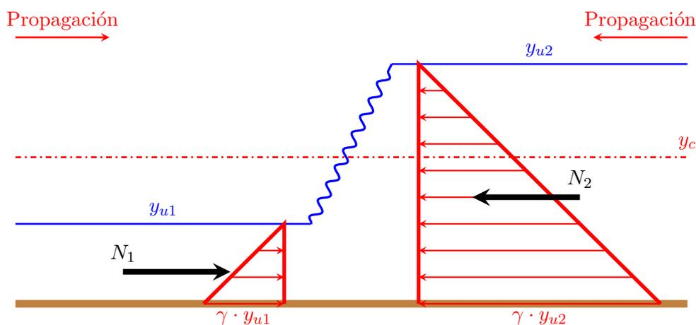
Figura 7.8: Representación de las impulsiones en un resalto
