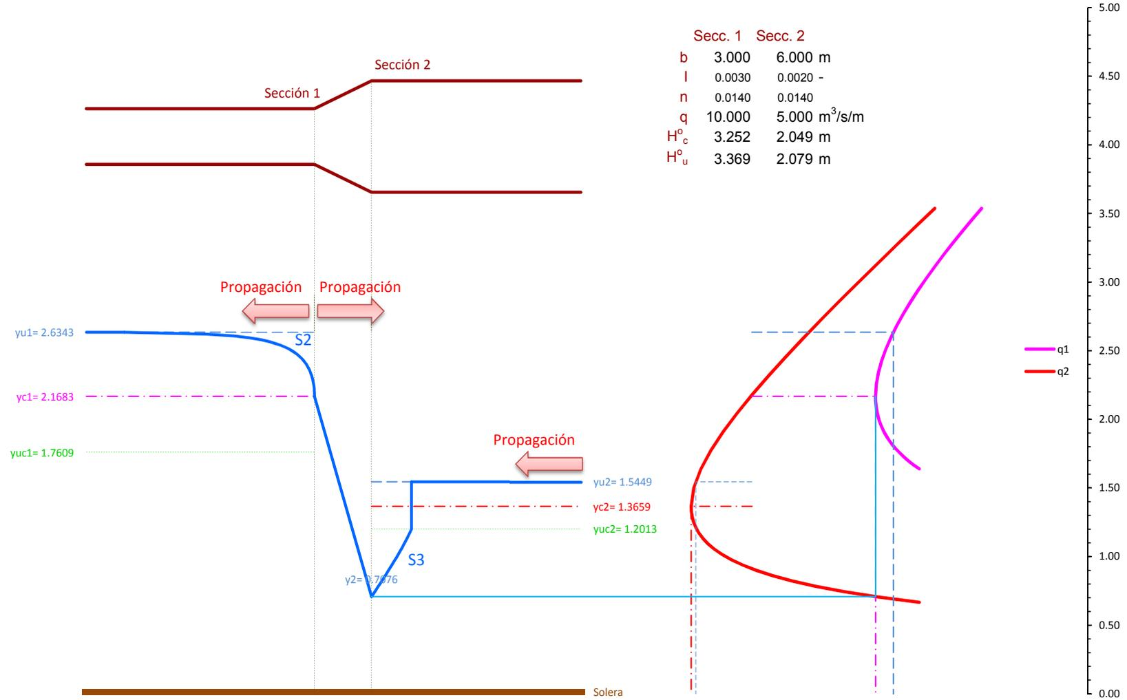
Figura 7.26: Ensanchamiento en régimen lento con cambio de régimen fuera de la transición
