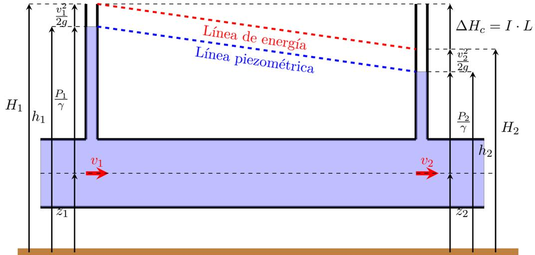
Figura 3.3: Líneas de energía y piezométrica
