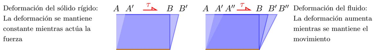
Figura 3.1: Deformación de un sólido rígido y un fluido
